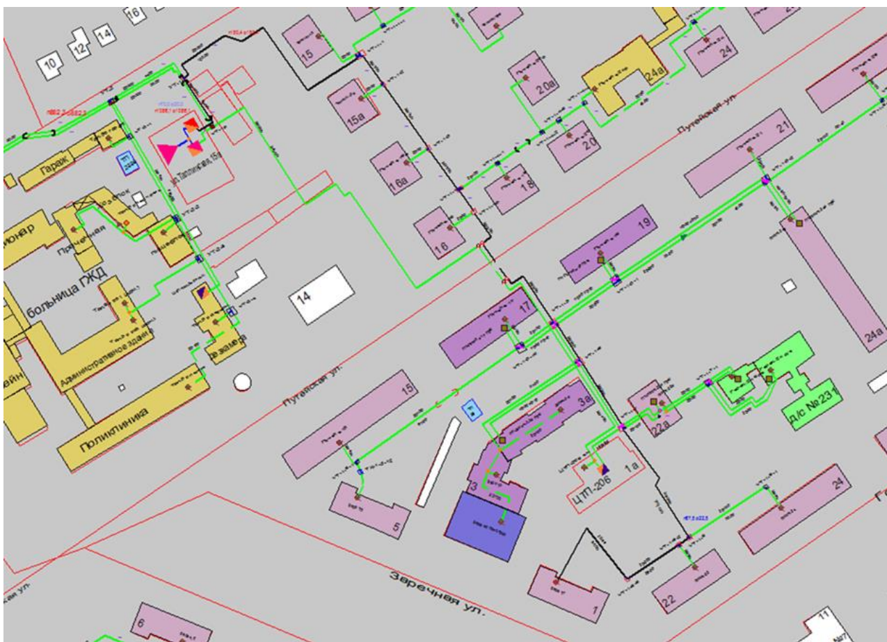
Рисунок 3.108 – Трассировка теплопровода от котельной АО «Теплоэнерго» по ул. Таллинская, д. 15В до конечного потребителя «ПТ-Зареч,1»
