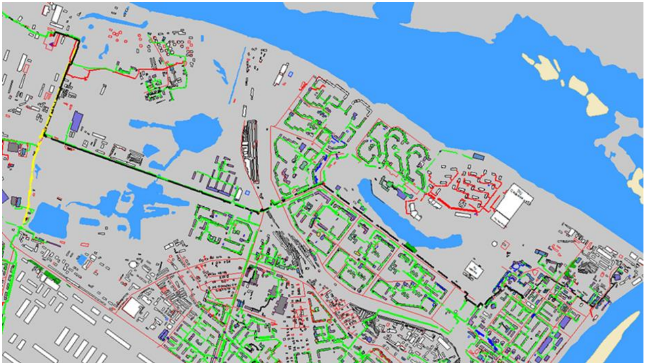
Рисунок 3.7 – Трассировка теплопровода от Сормовской ТЭЦ до конечного потребителя «ПТ-Стрел,19»
