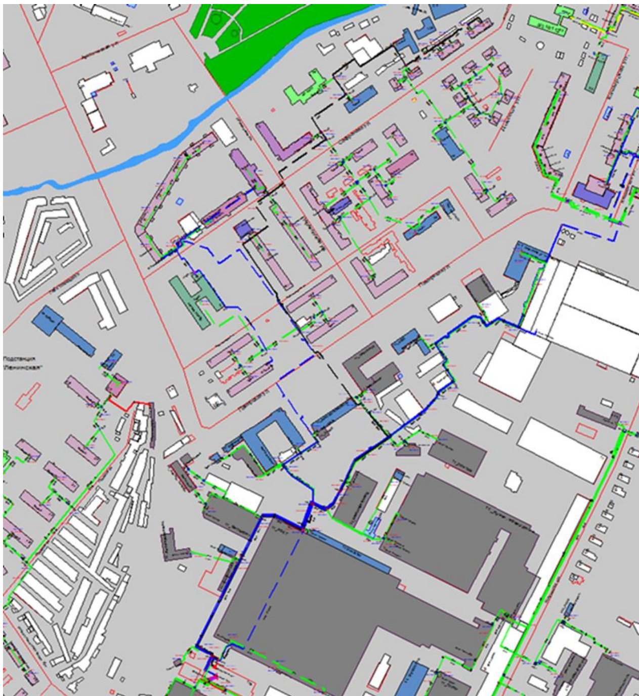
Рисунок 3.35 – Трассировка теплопровода от котельной АО «Теплоэнерго» по ул. Памирская, д. 11 до конечного потребителя «ПТ-Сафрон,15 вв2»
